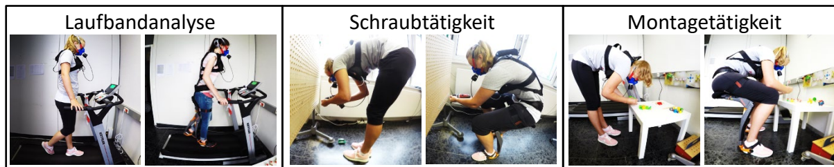
Abbildung 1: Während der Studie mussten drei verschiedene Tätigkeiten jeweils mit und ohne Exoskelett ausgeführt werden: eine Laufbandtätigkeit (links), eine Schraubtätigkeit (Mitte) und eine Montagetätigkeit (rechts)
