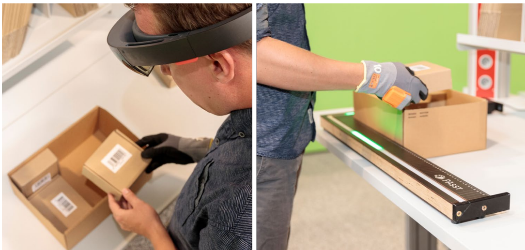
Abbildung 1: Experimenteller Versuchsaufbau (links: Proband mit AR-Brille, rechts: Proband mit LED-Assistent am Verpackungsarbeitsplatz)
