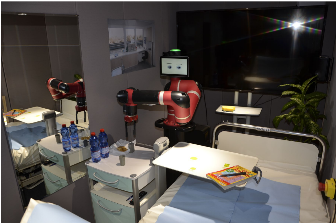
Abbildung 2: Exemplarische Anwendung eines robotergestützten Assistenzsystems im Pflegewesen, aufgebaut im Full-Scope Simulator (Quelle: eigenes Foto)
