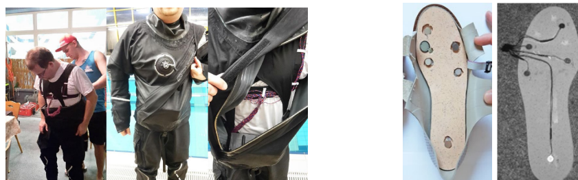
Abbildung 3: links: Vibrationsbrustgurt für Taucher zur Orientierung in Gewässern mit schlechter Sicht (beim Anlegen und unter dem Taucheranzug); rechts: Vibrationsschuhsohle zur Unterstützung von Navigationsaufgaben für Fußgänger (Vorder- und Rückseite)
